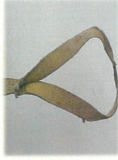
ห่วงสลิงฟ้าใบปริแยก (รอยเย็บเสื่อมสภาพ หรือ แตก)
